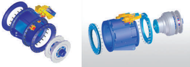
Po lewej stronie układ hamulcowy ze sprzęgłem elastycznym (podatnym), po prawej – ze sprzęgłem hydrodynamicznym
